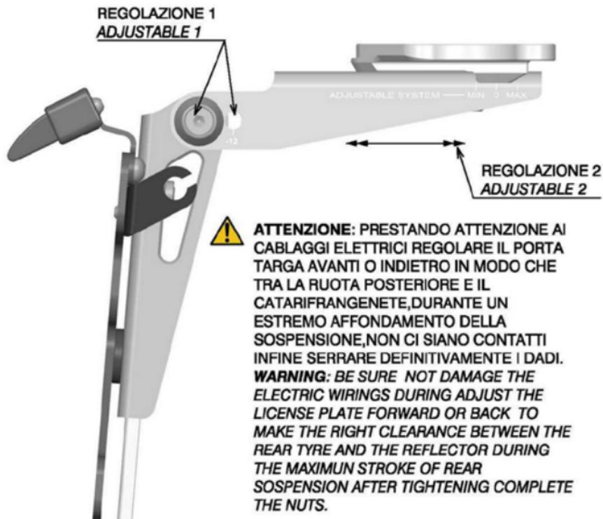
**ATTENZIONE:** PRESTANDO ATTEZIONE AI CABLAGGI ELETTRICI REGOLARE IL PORTA TARGA AVANTI O INDIETRO IN MODO CHE TRA LA RUOTA POSTERIORE E IL CATERIFRANGENTE, DURANTE UN ESTREMO AFFONDAMENTO DELLA SOSPENSIONE, NON CI SIANO CONTATTI INFINE SERRARE DEFINITIVAMENTE I DADI.
