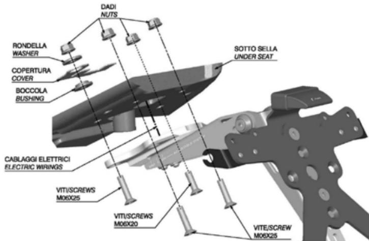
**ITA** ⚠ – Prima di fissare il porta targa al telaio infilare i cablaggi elettrici. (Fissando il porta targa evitare di schiacciare o danneggiare il cablaggio elettrico). Per facilitare la regolazione del porta targa (STEP 11) non serrare definitivamente i dadi.
